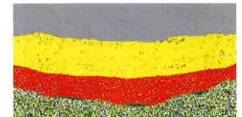
② ばくろによるコントロールの消耗(景観面でメンテナンスを考慮する時期)
